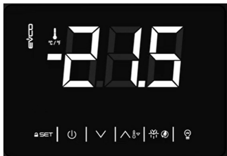
Fig.16 Interfaccia controller EVCO EVJ205
